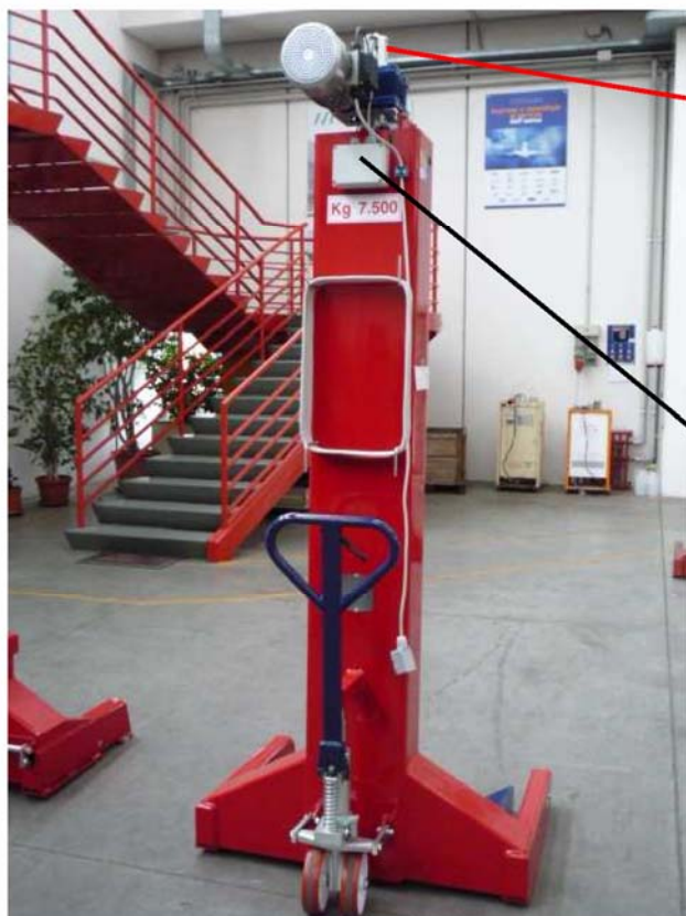
COLONNA CON DETTAGLIO ENCODER ASSOLUTO E SCHEDA MICROPROCESSORE
